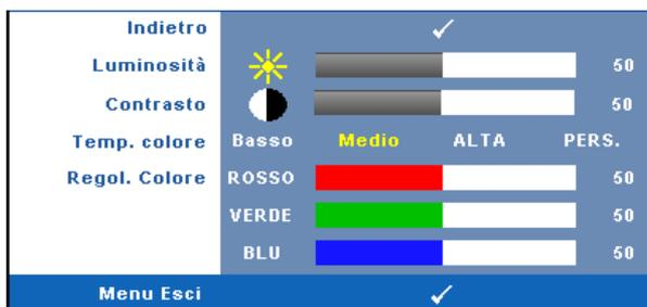
**LUMINOSITÀ**—Utilizzare ⏪ e ⏩ per regolare la luminosità dell'immagine.
