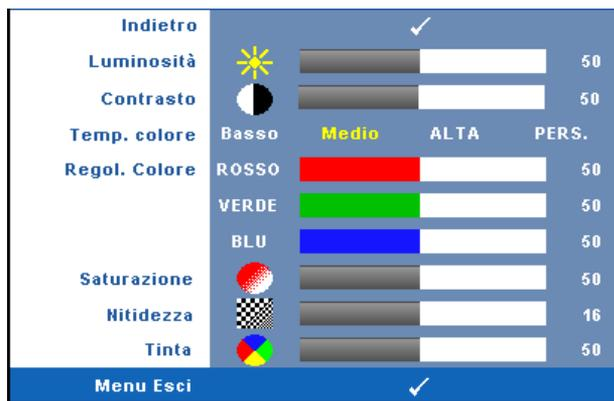
**LUMINOSITÀ**—Utilizzare ◀ e ▶ per regolare la luminosità dell'immagine.
